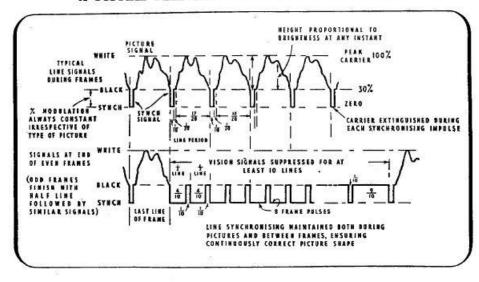
A TYPICAL TELEVISION TRANSMITTED WAVEFORM
